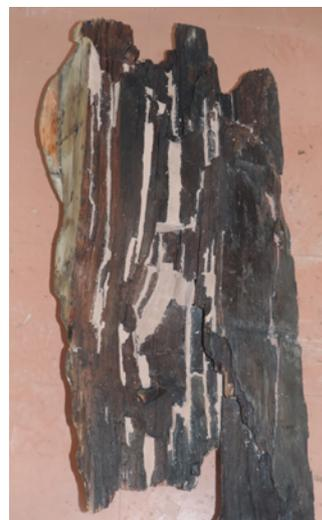
**Fig. 5.** Comblements structurels des cavités créées par le champignon lignivore au moyen d'une résine époxyde chargée (qui apparaît en rose).
