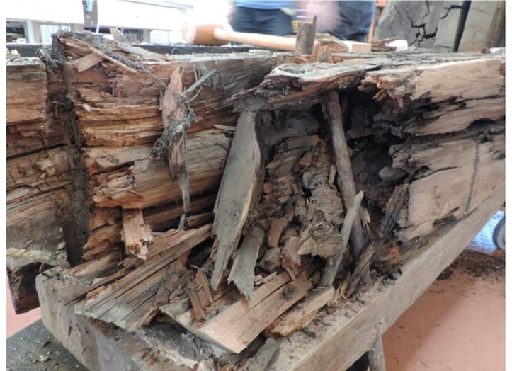
**Fig. 4.** Pourriture cubique et déstructuration de la partie interne de l'œuvre. © Atelier Régional de Restauration.
