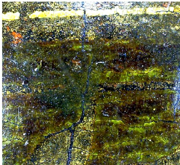
**Fig. 13.** *Idem*, détail de la feuille métallique sous microscope numérique, grossissement x 3,5. © Audrey Bourriot.
