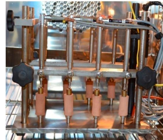
Figure 32 : banc dilatométrique pour mesurer les cycles de dilatation/contraction des argiles de référence avant et après traitement au SILRES.
