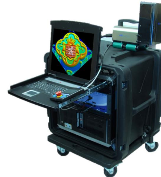
Figure 6 : station ALTI surf 50 utilisée pour les mesures de microtopographie
