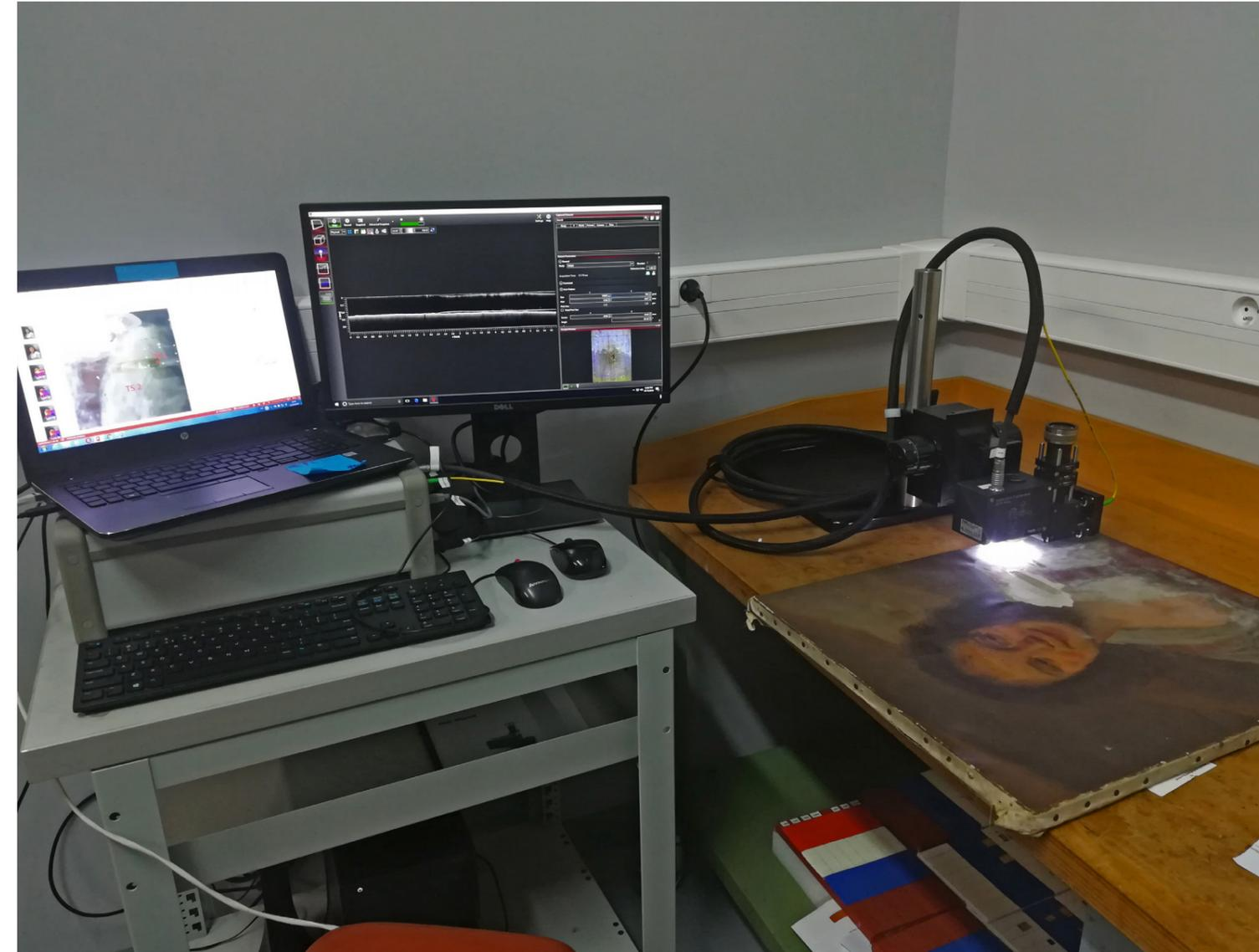
Figure 9 : Système OCT du C2RMF
